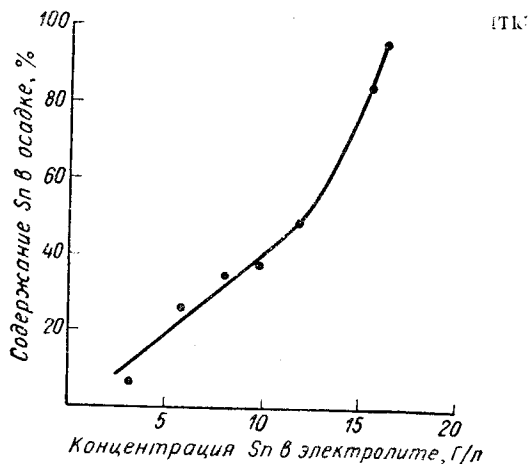
Рис. 33. Зависимость содержания олова в катодном осадке от концентрации олова в электролите ( t = 18^\circ \text{C} , D_k = 1,5 \text{ а/дм}^2 , [\text{Cd}] = 100 \text{ г/л} ).
